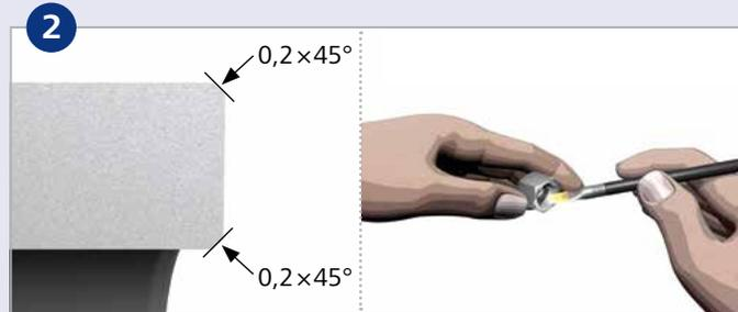
**2. Rohrenden leicht entgraten und Rohr reinigen.**
